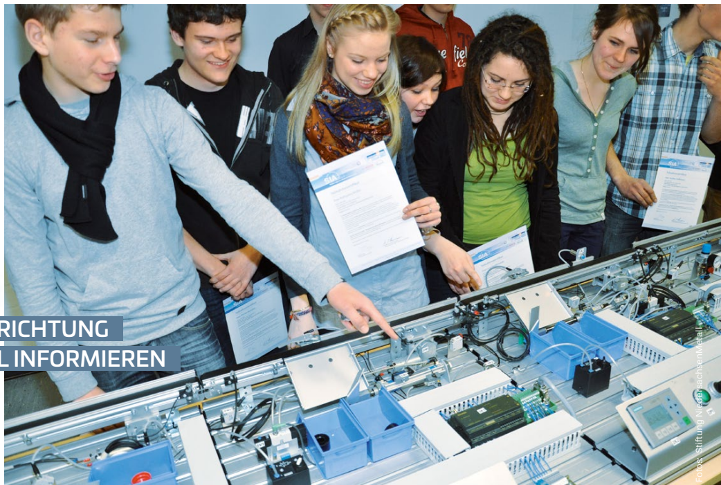
► Vollautomatisch und pneumatisch betrieben: Die Absolventen der SIA in Wolfenbüttel haben eine Reifensortieranlage gebaut.
